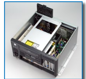
Massiver Laufwerkskäfig und leicht zu wartende Luftfilter
